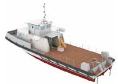
Chalands multi-missions (CMM), H2X, projet. Il sera propulsé par un moteur électrique pouvant être alimenté soit par des groupes électrogènes fonctionnant au gazoil (mode classique), soit par des batteries rechargeables aussi bien à quai ou en mer (mode « zéro émission »).
